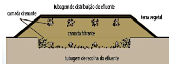
Figura 3-5 - Representação esquemática de um aterro filtrante (adaptado de Matos e Ferreira, 2018)
