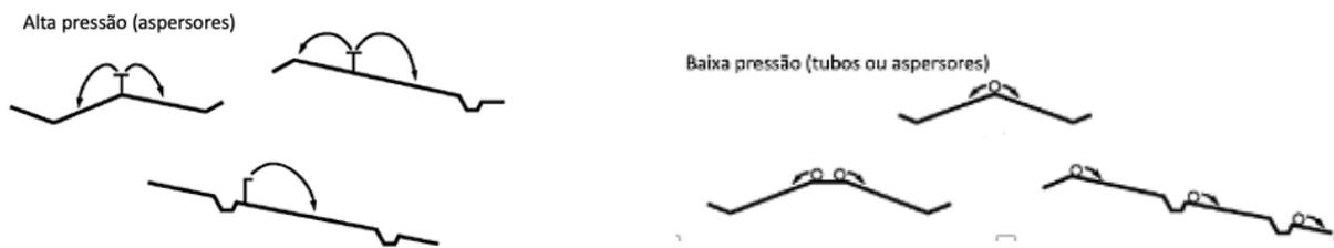
Figura 5-5 - Sistemas de distribuição alternativos para o sistema de Overland-Flow (Adaptado de Crites, 2000)
